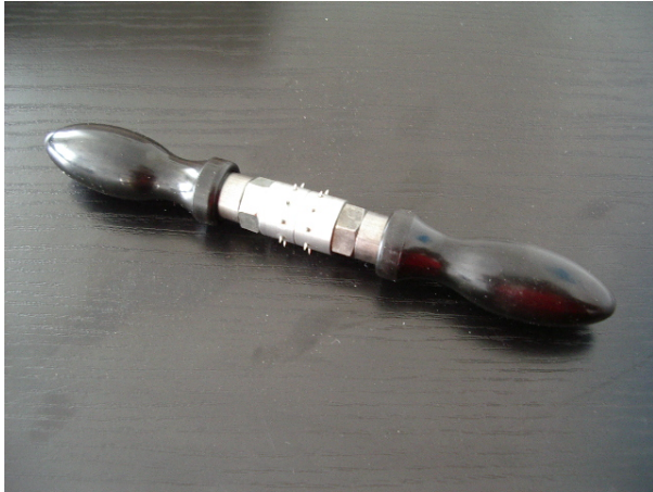
Markierungsroller 2-fach benadelter Aluminiumring mit gelagerten Handgriffen
