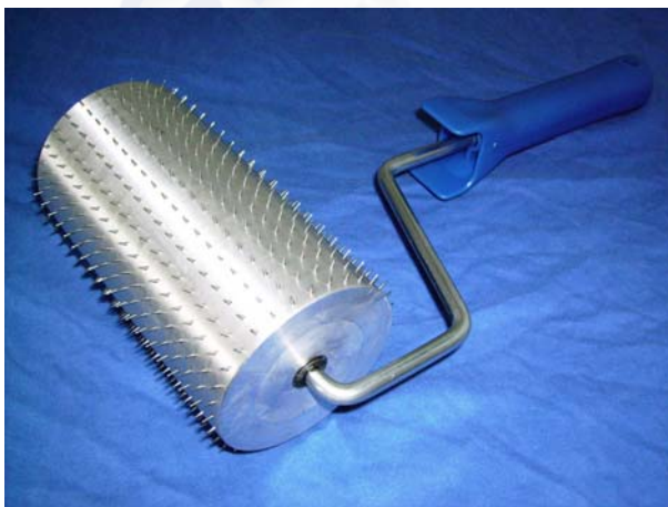
Handperforierroller Aluminium, gelagert mit Handgriff, groß
